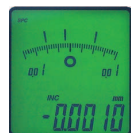
Przy przekroczeniu tolerancji kolor podświetlenia wyświetlacza zmienia się z zielonego na czerwony
