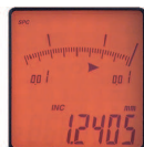
Przy przekroczeniu tolerancji kolor podświetlenia wyświetlacza zmienia się z zielonego na czerwony
