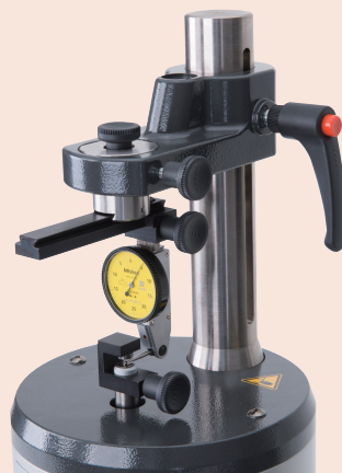
Wzorcowanie czujnika dźwigniowo-zębatego z dodatkowym wyposażeniem
